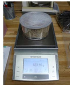
重さを測る。サンプルの重量が測定精度に大きく影響してくるのでできるだけ重くします。
